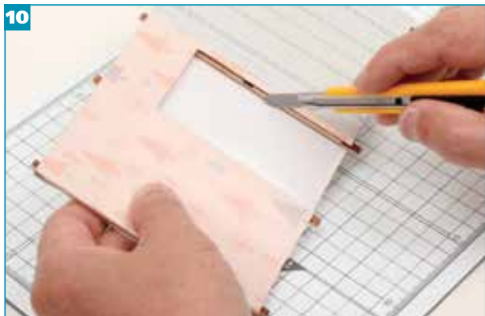
10 Переверните стену и с помощью канцелярского ножа вырежьте дверной проем.
