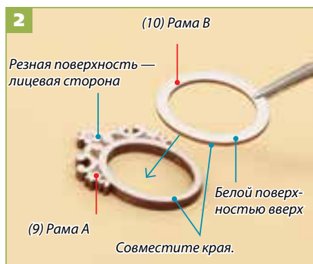
2 Раму А положите резной поверхностью вверх и при помощи клея сверху прикрепите раму В.
